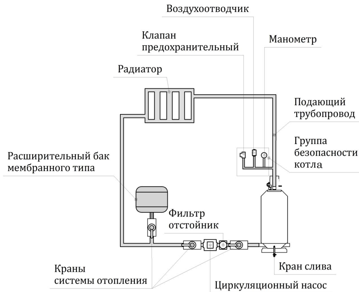
Рисунок 14 – Схема закрытой системы отопления с принудительной циркуляцией
