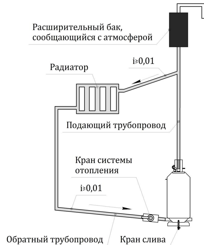
Рисунок 13 – Схема открытой системы отопления с естественной циркуляцией
